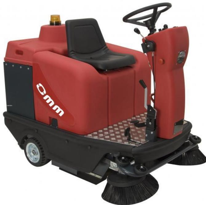
Incluye faros delanteros y traseros. Incluye los dos cepillos laterales. Gran capacidad. Cómoda conducción. Excelente rendimiento de trabajo. Alto nivel de aspiración y recogida. Tracción electrónica. Flap para recogidas de objetos medianos. Parachoques frontal. Filtro a panel de poliéster, disponible también con 6 filtros de cartucho. Tecnología y diseño OMM, grandes resultados.
